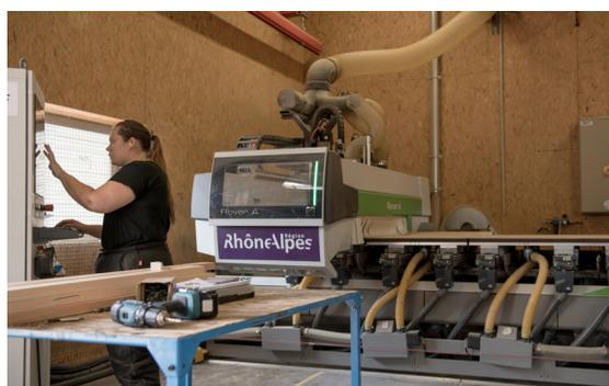
Centre d'usinage à commande numérique 5 axes
