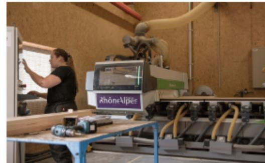
Centre d'usinage à commande numérique 5 axes | Les Grands Ateliers, 2019
